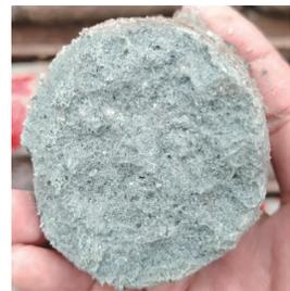
图4 127~450.2 m砾石-粗砂-中砂-细砂互层岩心
