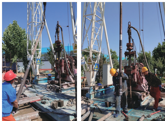
图14 H口径液力举升绳索取心钻具下孔实验
