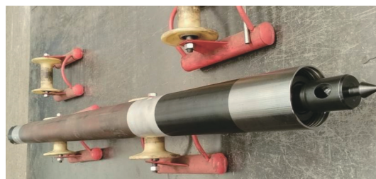
图13 H口径液力举升绳索取心钻具
