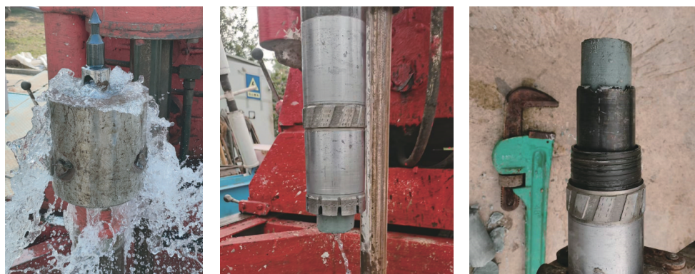
图15 内管成功举升获取的完整水泥岩心
