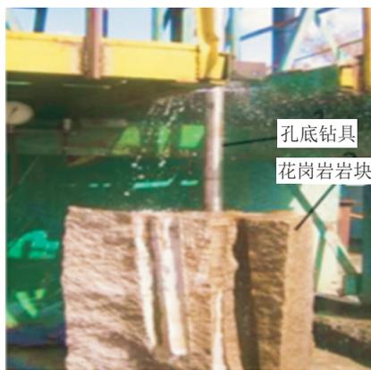
图7 在花岗岩岩块中打出的钻孔
