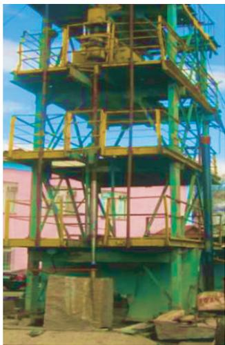
图6 试验钻进用的试验台
