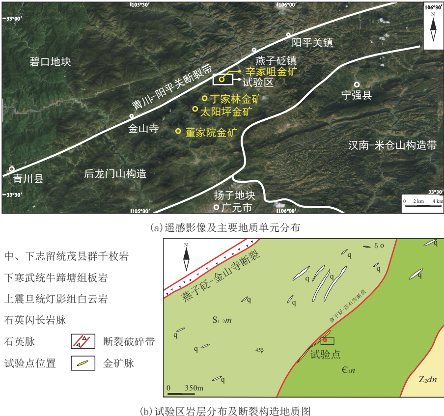
图1 以钻代槽野外试验区遥感影像与地质略图
