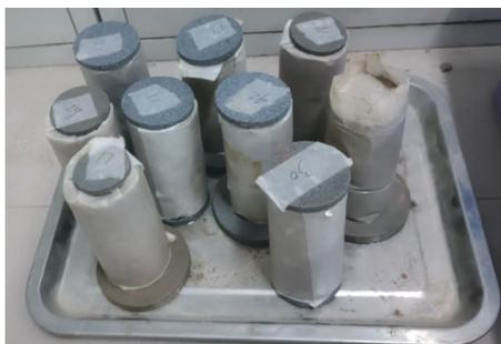
图5 岩石膨胀性试验样品照片
