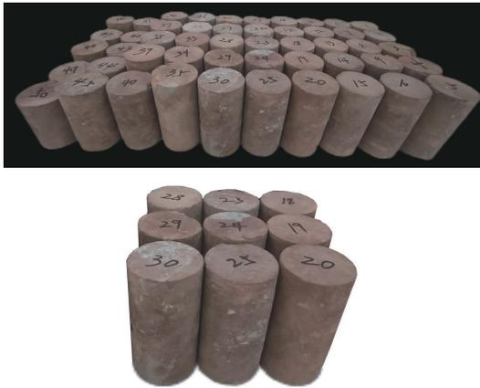
图6 岩石崩解性试验样品照片
