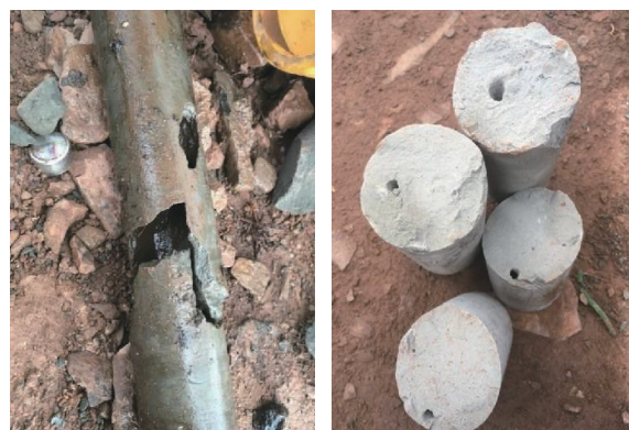
(b)套管内水泥柱被抽吸形成的贯穿通道
