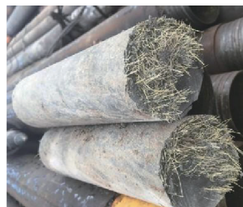
(a)套管内加筋增阻的水泥柱
