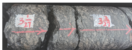
图10 垮洪洞组强水敏性泥岩
