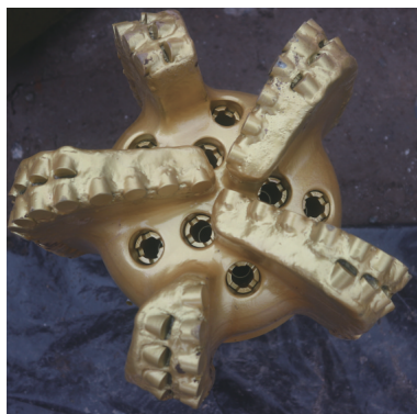
图8 五刀翼双排齿高效PDC钻头
