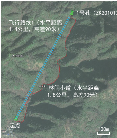
图 12 ZK20101 人工/无人机搬迁路线 Fig.12 ZK20101 manual/drone relocation route
