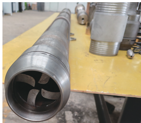
图9 光圈收敛式特种取心取样钻具
