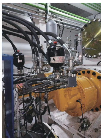
图9 增加蓄能器试验测试
