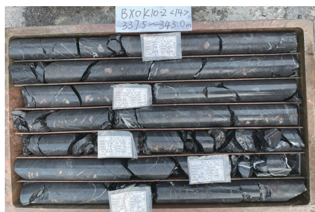
图4 定向钻孔岩心照片
