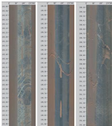
(c) 钻孔结构面解译结果
