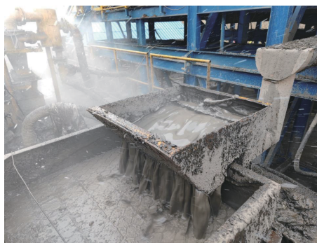
图3 出口钻井液流动状态
