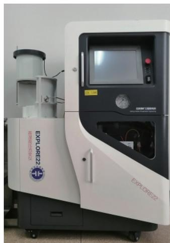
图4 超高温高压流变仪实物
