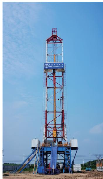
图2 5000米智能地质钻探岩心钻机
