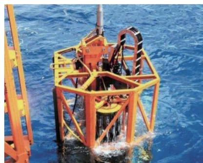
图11 “海牛号”深海海底深孔钻机系统
