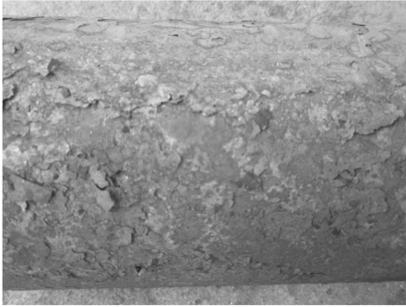
图3 普通加热调质后的钻杆表面情况
