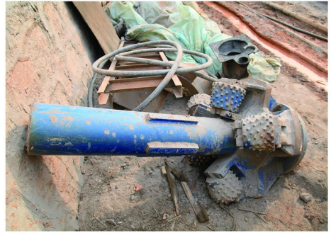
图8 \text{Ø}311/850 mm反井扩孔钻头
