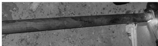
图6 无缝管岩心管
