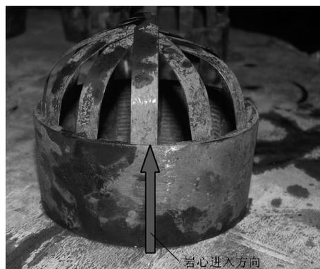
图5 松软煤层绳索取心用的爪簧
