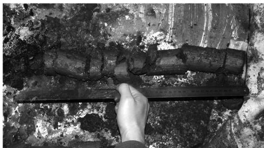
图2 2013ZX-SH-UM15V井钻遇的3号、15号煤层中下部煤样
