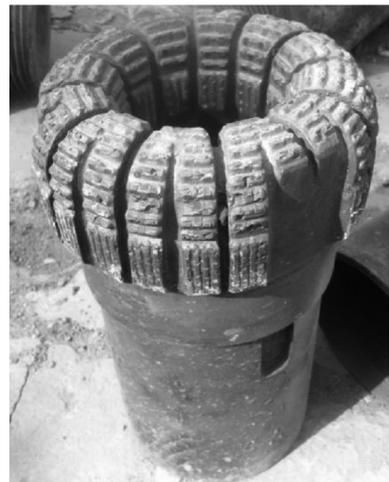
图4 Ø215.9 mm 的孕镶金刚石取心钻头
