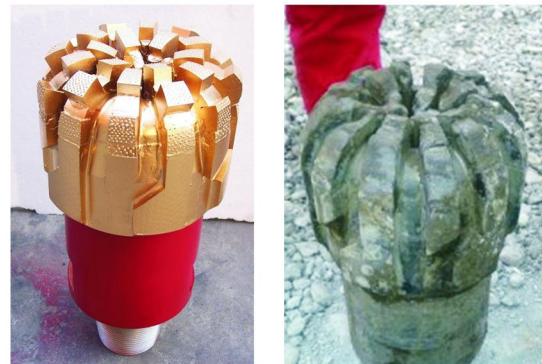
图 7 NR826M 钻头入井前后照片
