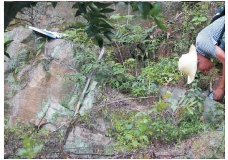
图 3 滑坡左边界基岩出露
