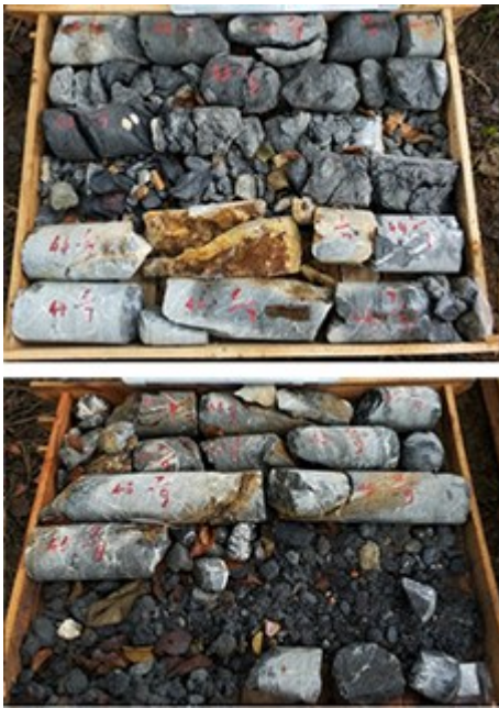
图6 ZK-15探采结合水井破碎岩心
