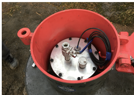
图8 试验现场安装井口密封装置
