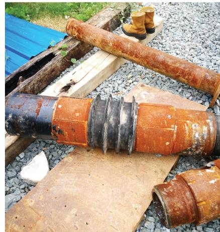
图9 使用后的封堵工具
