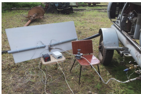
图3 旋流制冷器试验装置照片 Fig.3 Photo of vortex cooler testbed
