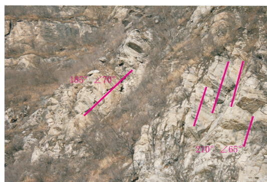
图 7 K3+620~640 段边坡岩体结构图
