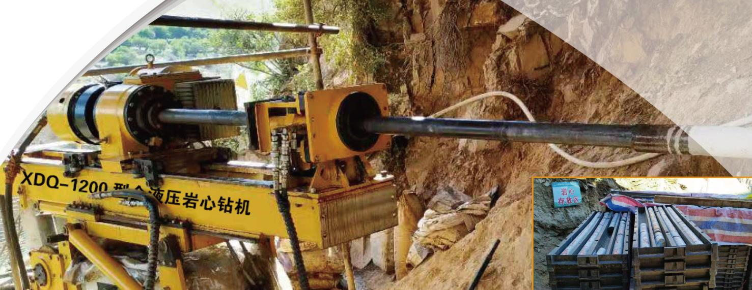
XDQ-1200型全液压岩心钻机是我厂在对比国内外同类设备的优缺点的基础上,针对绳索取心的工艺特点,自主研发的一种专门针对山区、丘陵地带,适用于中深孔取心钻探可拆解适合人工搬迁的岩心钻机。
